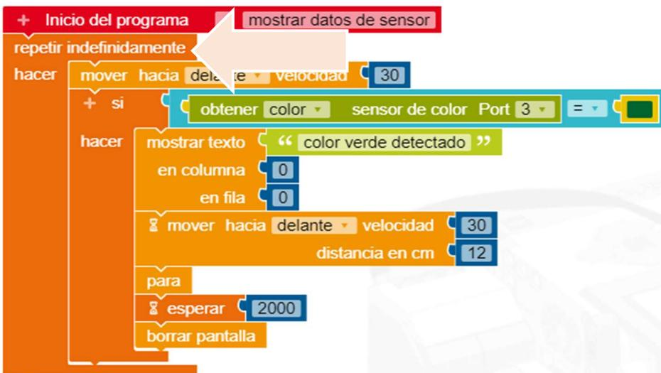
El siguiente bloque de instrucción que se utiliza es “mover hacia”, esto hará que el robot se mueva hacia adelante a una velocidad de 30 m/seg.
